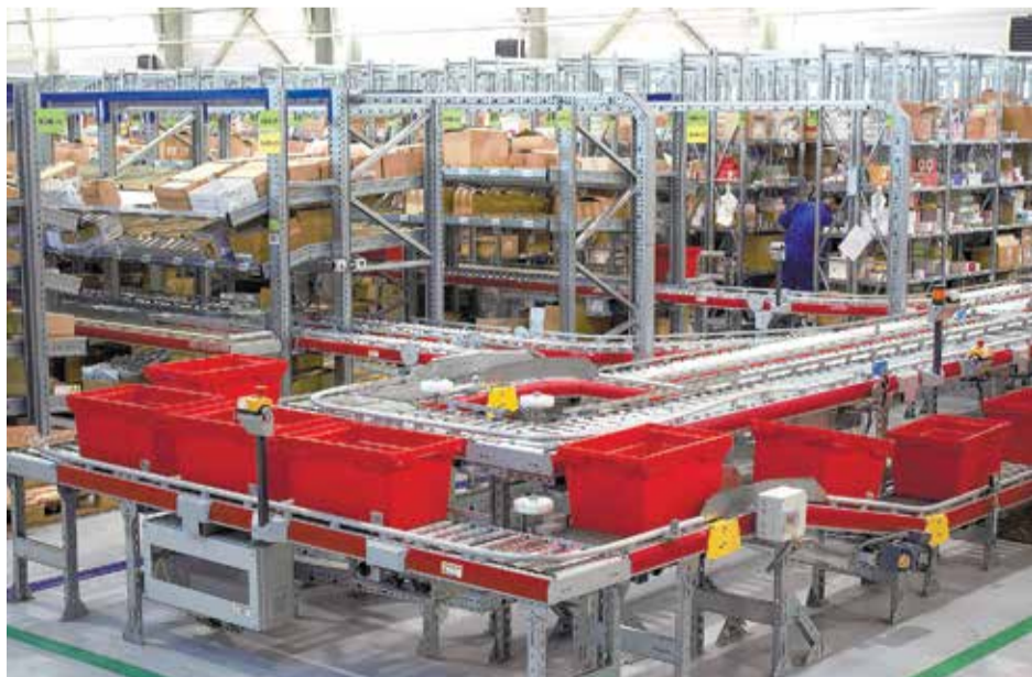
Склад с высотным хранением 7 уровней, оснащен автоматизированной конвейерной линией SSI SCHAEFER Австрия
